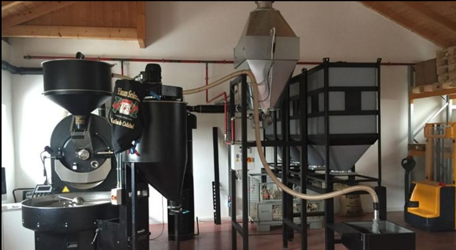
Geeignet für Röster von 30 bis zu 60 kg/Charge mit einer Leistung von bis zu 600 Nm<sup>3</sup>/h
