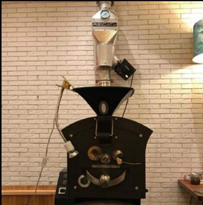
Geeignet für Röster für bis zu 5 kg/Charge mit einer Leistung von bis zu 100 Nm<sup>3</sup>/h
